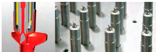
Rys. 5 | Wtrysk pod kątem
